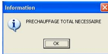
Si le tube n'a pas été utilisé à kV maximum pendant plus de 30 jours, un préchauffage total (complet) sera imposé.
