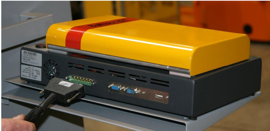
Un seul des connecteurs est relié au générateur RX. Ce connecteur industriel SUBD 24 sert à amener l'énergie nécessaire au fonctionnement de la LS1 et établit également la communication entre la LS1 et le générateur. La connexion avec le générateur doit être établie avant de démarrer celui-ci et ne doit pas être interrompue en cours d'utilisation.
