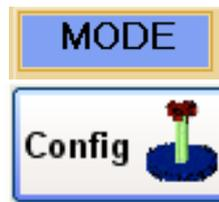
Le mode "Configuration" permet à l'utilisateur de partiellement personnaliser l'environnement de la LS1. En sélectionnant le bouton correspondant, la boîte de paramétrage apparaîtra dans la zone centrale de la fenêtre principale.
