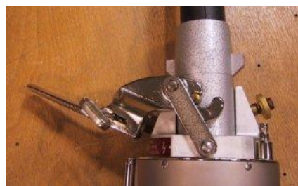
Mise à pression à l'aide de la quick flange
