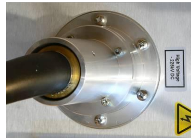
Câble HT avec bague à visser en aluminium
