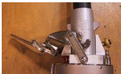
Mise à pression à l'aide de la quick flange
