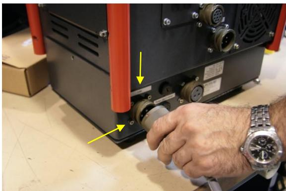
Placer le câble de connexion entre le kit 110V et la DCP (longueur de 30 cm)
