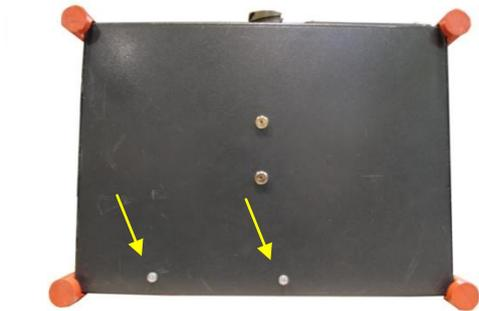
Pour les prochaines opérations, utilisez une clé 6 pans T4 pour dévisser les vis sur les 2 cotés latéraux de la DCP.
