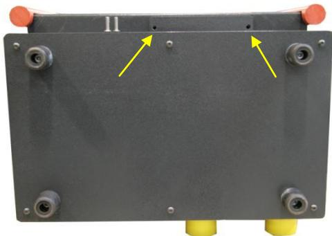
Fixez les 2 vis TC 6PC M5x12mm avec les rondelles Schnoor diam. M5 en dessous de la DCP.
