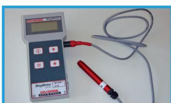
Le **MF300F**, portable et robuste, détermine le pourcentage et le nombre de ferrite dans les inox.
