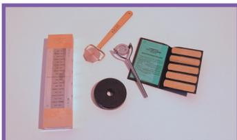
Pour les conditions d'aimantation : **croix de Berthold, témoin ASME, indicateurs Castrol, cale et disque SNECMA.**
