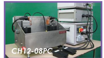
**Gamme de bancs polyvalente et économique** pour la formation, la prestation et autres. Passage de courant (électrodes), passage de champ (solénoïde ou têtes magnétiques), AC, R1A. Intensité selon modèle. Cabine disponible en option.
