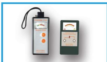
Les **mesureurs d'humidité**, sont des appareils de contrôle non-destructif très simples d'emploi, estimation instantanée du taux d'humidité des bétons, bois, fibre de verre, plâtre...
