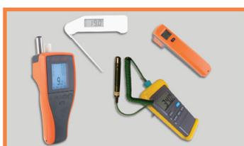
**Mesure des températures de l'air, des surfaces et des liquides, de l'humidité relative et du point de rosée avant l'application des peintures :**
