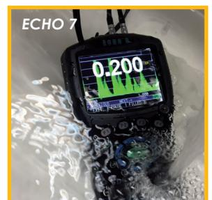
**Série UPG 07** : Ils existent soit avec écran LCD, soit avec écran couleur dans des versions avec alarmes, mode différentiel, gain réglable, visualisation du signal AScan. La version la plus haut de gamme permet de régler tous les paramètres ultrasons et de les stocker en mémoire pour un rappel rapide.
