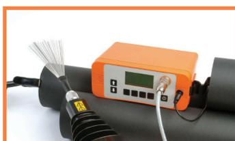
Le **D266** calcule la tension à utiliser en fonction de l'épaisseur de revêtement, la sécurité opérateur est renforcée. Il a été spécialement conçu pour révolutionner le contrôle des revêtements par courant continu, en rendant le test plus sûr, plus simple et plus fiable.
