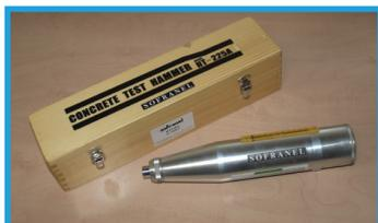
Le **SCLÉROMÈTRE** est un appareil de mesure de dureté par choc permettant d'évaluer la résistance du béton.
